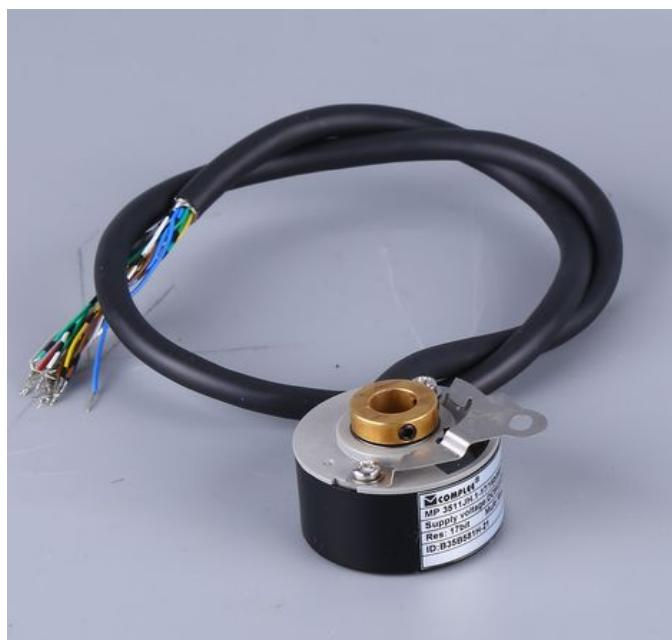
康比利公司推荐选型注意编辑应注意三方面的参数：1、机械安装尺寸：包括定位止口，轴径，安装孔位；电缆出线方式；安装空间体积；工作环境防护等级是否满足要求。2、分辨率：即编码器工作时每圈输出的脉冲数，是否满足设计使用精度要求。3、电气接口：编码器输出方式常见有推拉输出(F型HTL格式)，电压输出(E)□集电极开路(C)□常见C为NPN型管输出□C2为PNP型管输出)，长线驱动器输出。其输出方式应和其控制系统的接口电路相匹配。期待你的来电。上海电梯编码器使用注意事项。吉林质量编码器厂家直销
