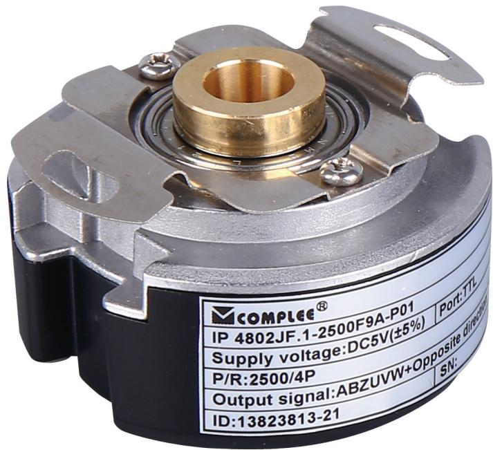
康比利为您介绍旋转变压器和编码器的主要区别：1、编码器更精确采用的是脉冲计数；旋转变压器就不是脉冲计数，而是模拟量反馈。2、编码器多是方波输出的，旋转变压器是正余弦的，通过芯片解算出相位差。3、旋转变压器的转速比较高，可以达到上万转，编码器就没那么高了。4、旋转变压器的应用环境温度是-55℃到+155℃，编码器是-10℃到+70℃。5、旋转变压器一般是增量的。两者根本区别在于：数字信号和模拟正弦或余弦信号的区别。
